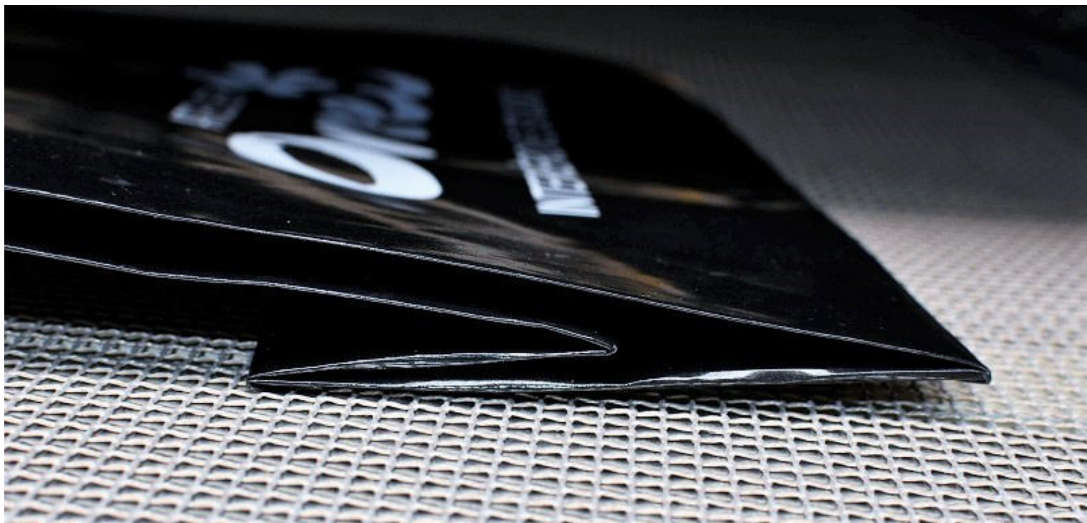
Detail ohybu tašky na běžícím pásu pece
