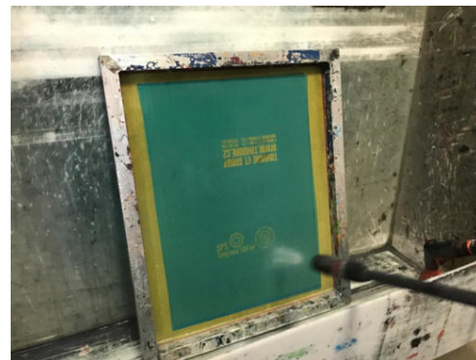
Rám s hotovým osvitem je třeba umýt od nezatvrdlé emulze.
