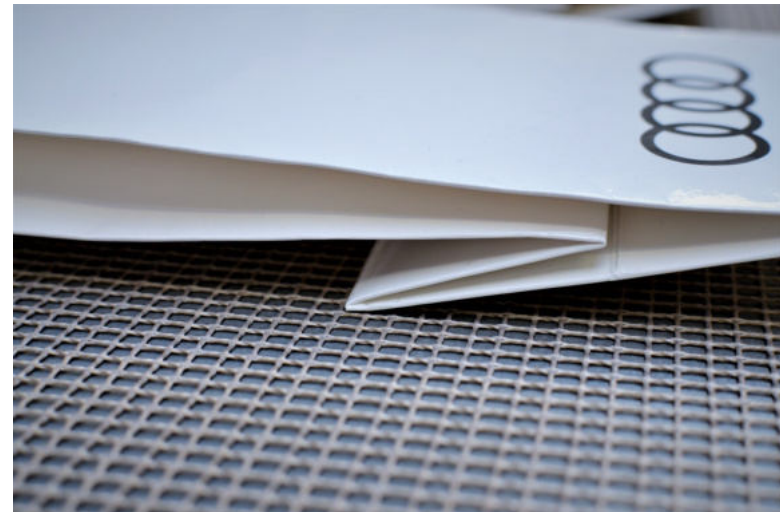
Detail tašky, kde vidíte malý prostor v ohybu tašky na zadní straně, kam je problém dostat dostatečnou teplotu pro zapečení.
